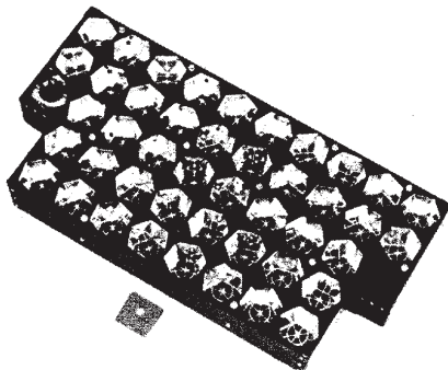
NTS-2 laser reflector. (Buisson-1977, p. 194)
